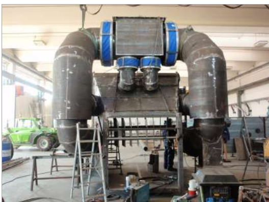
sistema di fresh air con compensatori di dilatazione tessili fresh air system with fabric expansion joints
